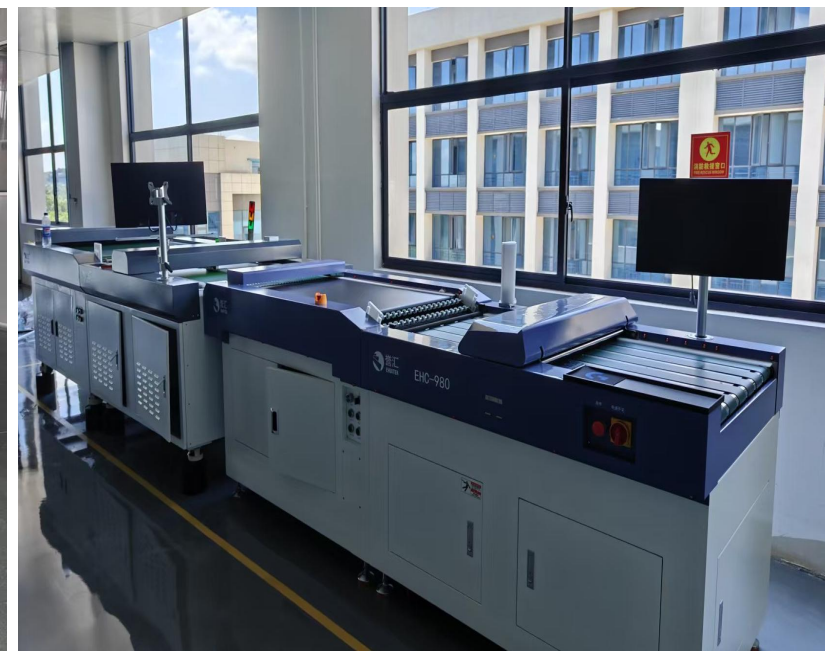
数孔机 Drilling Hole Check
